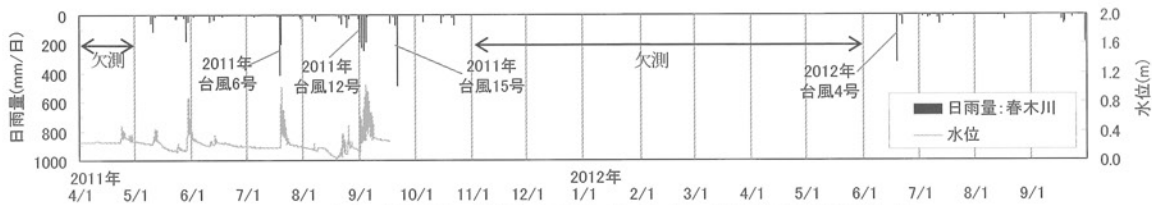
図-3 春木川観測所の観測日雨量と春木川第一砂防堰堤の観測水位
