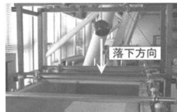
写真-3 実験水路の概況と落下前のボウリング球の状況
