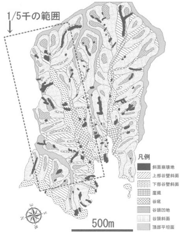
図-10 1/1万衛星画像による山地斜面(斜面崩壊地)
