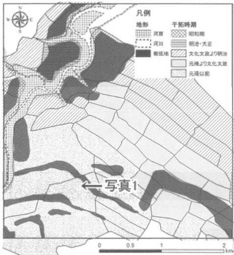
図-9 諫早湾干拓の歴史と衛星写真判読による不同沈下
