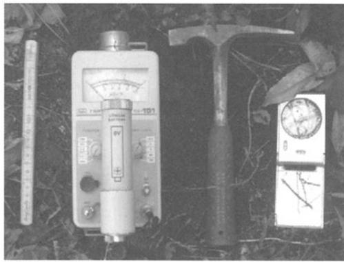
写真-1 ガンマ線探査に用いた測定機器と用具。
