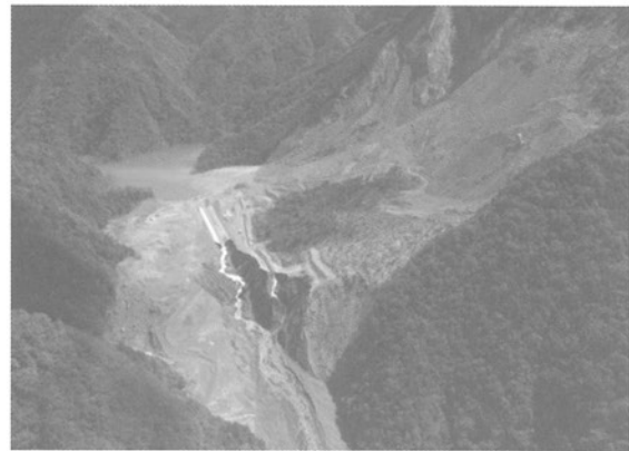
写真-4 栗平地区天然ダム箇所 (閉塞土塊の侵食遡上, 撮影; 近畿地方整備局)
