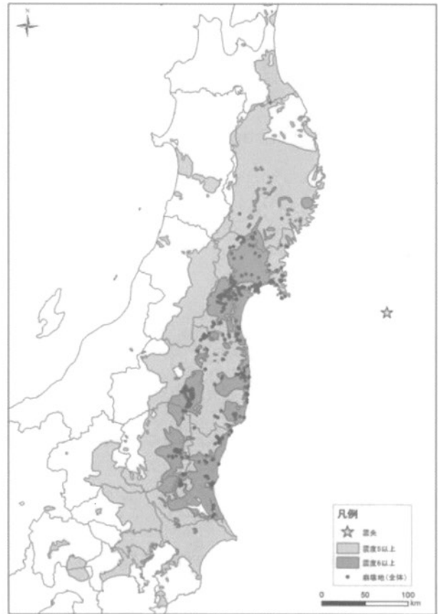
図-2 東北地方太平洋沖地震で発生した崩壊と震度の分布
