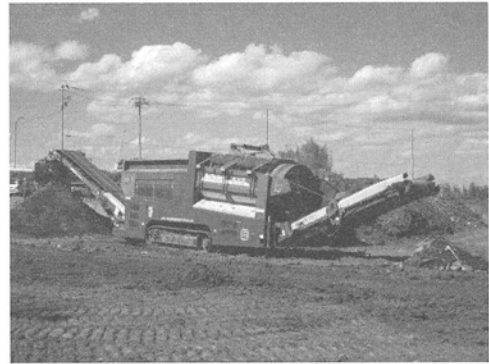
写真-7 ガレキの除去に用いたトロンメル
