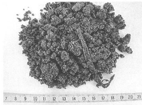
写真-3 砂質系の津波堆積物
