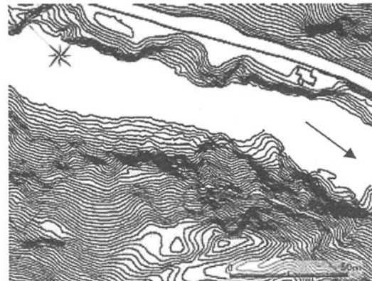
図-4 等高線に乱れが認められる箇所の例
