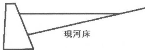
図-5 砂防ダム上流の望ましい堆積状態
