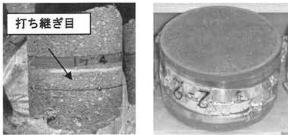
写真-1 コア(左)及び供試体(右)の状況
