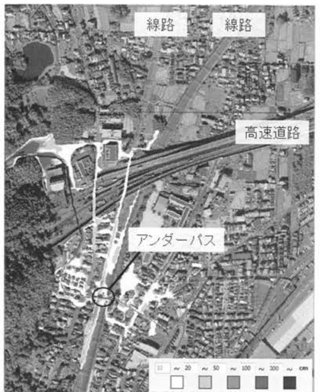
図-7 計算開始 600 秒後の痕跡 (家屋および流路工の考慮あり)
