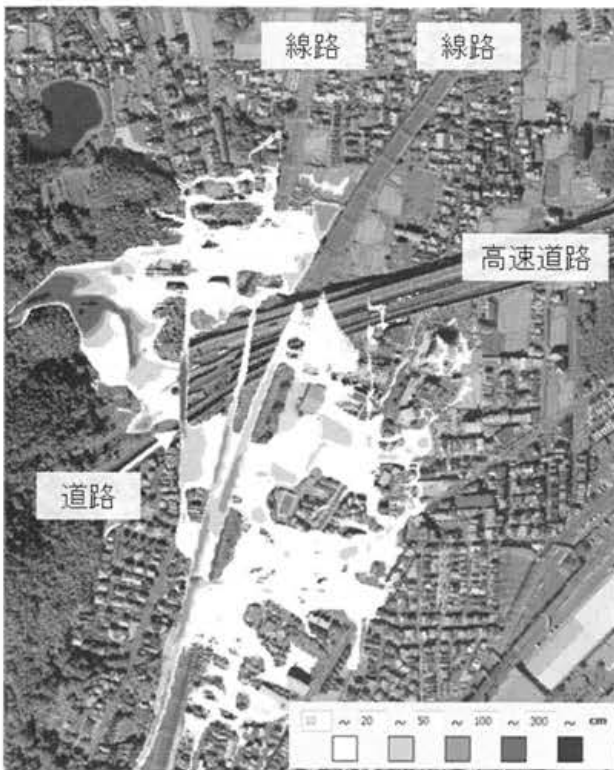
図-6 計算開始 600 秒後の痕跡 (家屋および流路工の考慮なし)
