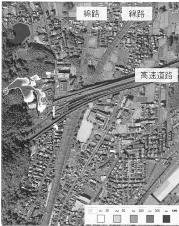
図-4 計算開始 600 秒後の堆積厚 (家屋および流路工の考慮なし)
