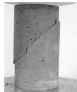
写真-2 ワイヤ・ブラシ清掃処理の供試体破壊状況
