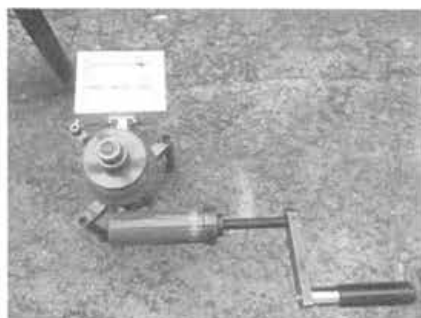
写真-5 建研式接着力試験機の概要 12)
