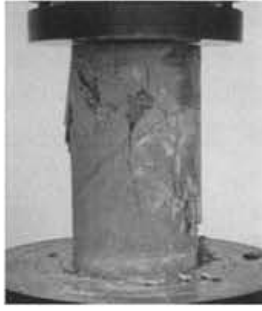
写真-3 繊維補強ポリマー・セメントにより処理された
