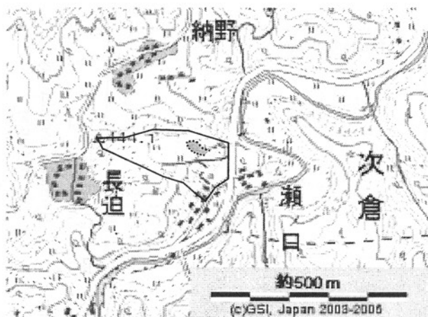
図-4 瀬の口地区における崩壊斜面周辺の地形図 (実線は崩壊斜面を含む集水域、点線は崩壊地)
