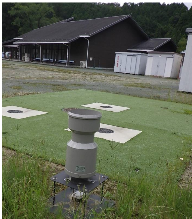
写真-1 雨量計設置の様子（築羽会館）
