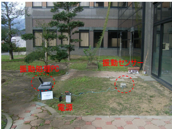
図-6 観測局設置候補地での常時微動調査の例
