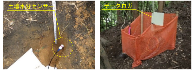
写真-4 センサー設置状況
