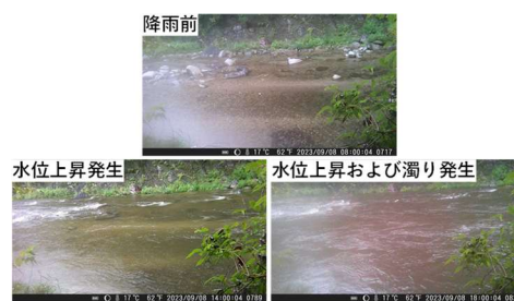
図-2 河道内での水位上昇、濁りの判定画像 (wt14).
