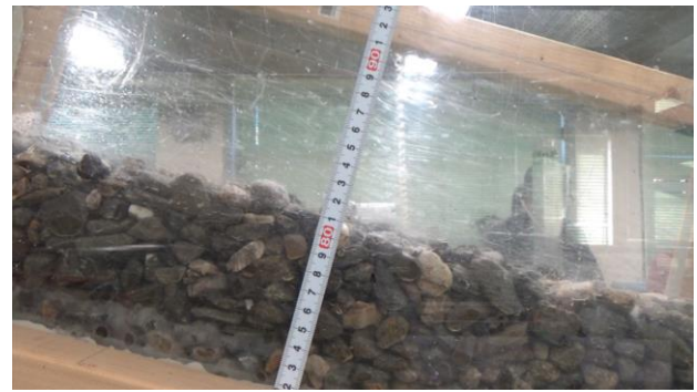
図-2 土砂の敷設状況 ( \theta = 15^\circ )
