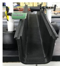
図-2 樹脂製 U 字溝を用いた水路 (下流正面から)
