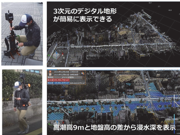
図-11 GEOSLAMによる地形の三次元点群表示と高潮浸水深の表示例（2021. 11. 24 計測）
