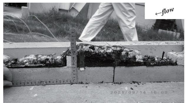
図-10 固結後の堆積形状 (CASE1-2)
