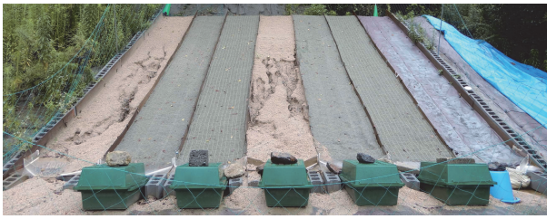
裸地_1 侵食防止 BSC 裸地_2 侵食防止 BSC マット_1 マット_1 マット_2 マット_2
