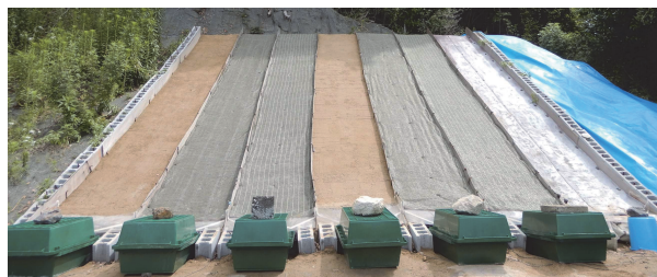
裸地_1 侵食防止 マット_1 BSC マット_1 裸地_2 侵食防止 マット_2 BSC マット_2
