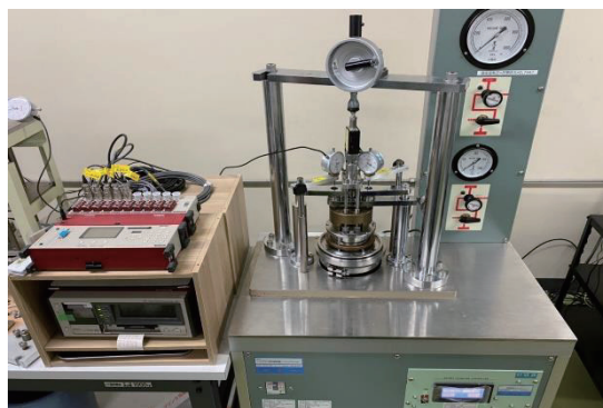
写真-1 単調荷重試験に用いた圧密定圧定速リングせん断試験装置
