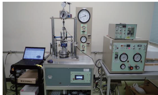
写真-2 繰返し荷重試験に用いた静・動的荷重兼用小型リングせん断試験装置
