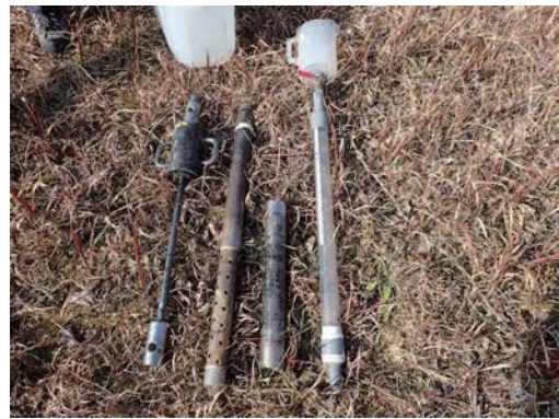
写真-4 原位置透水試験装置
