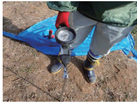
写真-3 ベーンコーン貫入試験
