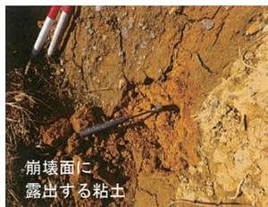
図-5 強風化砂質粘土
