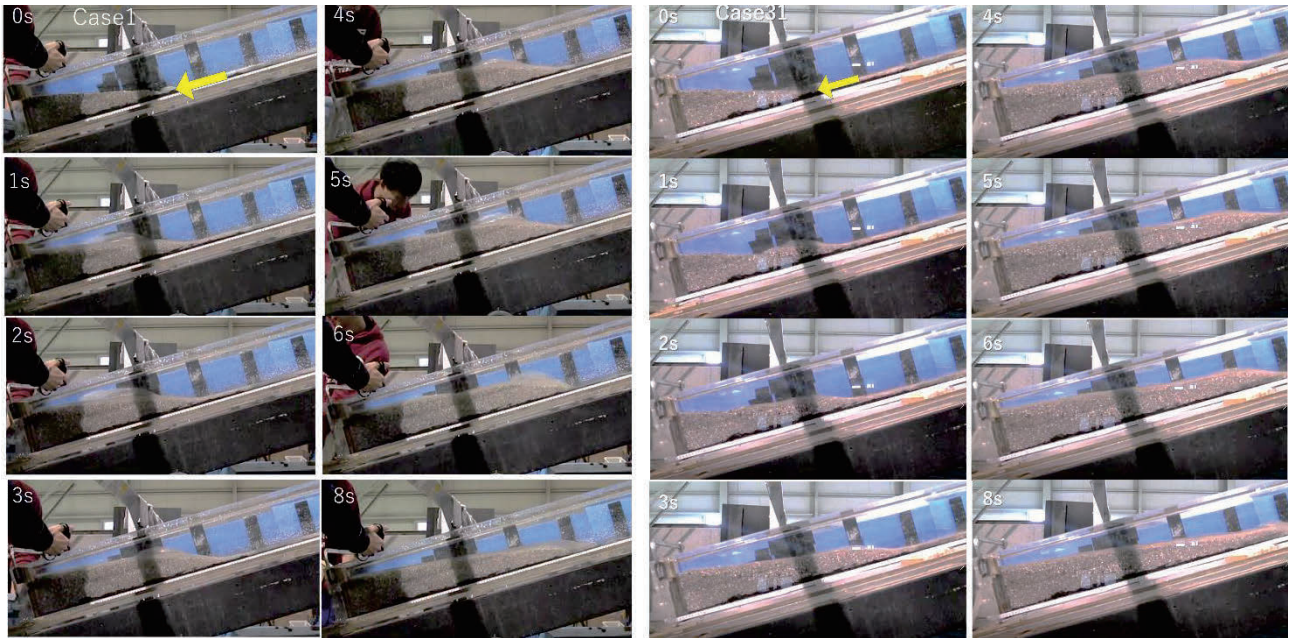
図-3 堰堤高 13 cm, 堆砂 A の Case 1 (左: 初期堆砂, 飽和) と Case 31 (右: 初期堆砂, 不飽和) に土石流が堆砂の上流端部に到達した時刻 (0s) から 8s 後までの挙動.
