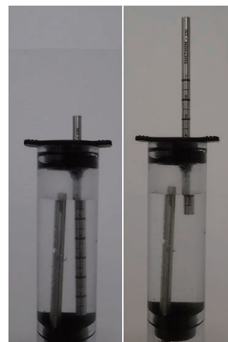
写真-2 圧力水頭調整チューブ (左は -6 [cmH 2 O]、右は -1 [cmH 2 O] に設定した時の状況)
