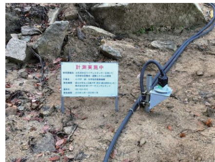
図-7 センサーを地盤内に設置した状況
