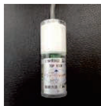
図-3 地盤変位の計測に採用した傾斜計
