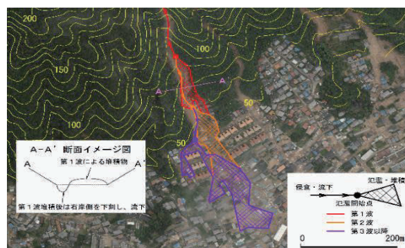
図-1 2014 年広島土砂災害における八木 3 丁目付近の土石流の氾濫
