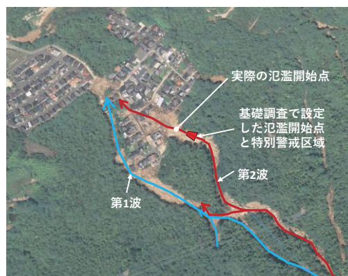
図-2 熊野町大原ハイツの土石流（写真：平成 30 年 7 月西日本豪雨に関する情報、国土地理院）
