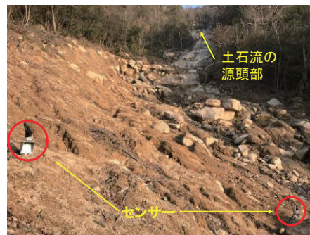
図-8 センサーの位置と源頭部の関係(測点⑤)
