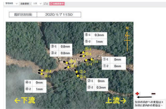
図-10 溪流内の地盤変位図の表示例
