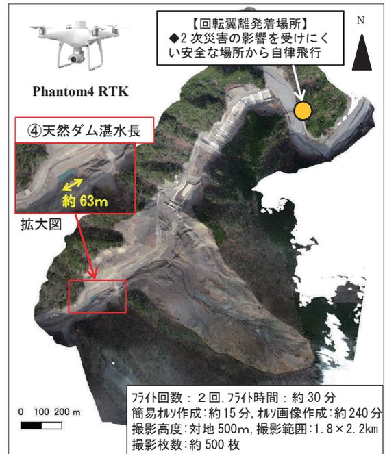
図-6 回転翼を用いた天然ダムの詳細調査 (Step2-1)
