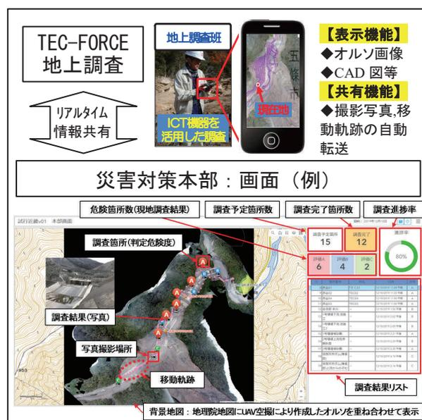
図-9 ICT 機器 (SMARTSABO) を用いた現地調査の例 (Step3)
