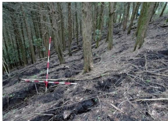
図-5 熊本地震により発生した無数の亀裂(平成28年4月23日筆者撮影)。撮影地点は図-2, Cに示している。
