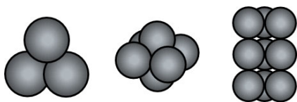
図-3 落石モデル (左から三角形、塊状、長方形)
