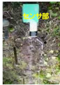
写真-2 保護管無しの設置状況
