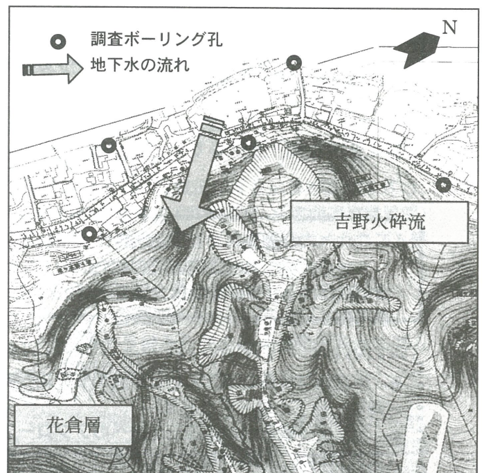
図-6 カルデラ壁頭部の花倉層上部における地下水の流れ（概要図） 7), 9)ほか
