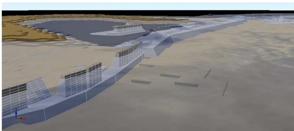
図-4.13 I港における防波堤倒壊計算のスナップショット
