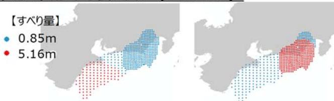
図-2.2.4 5地震総合モデル，東海・東南海・南海，東海・東南海の各地震モデルのアスペリティの設定
