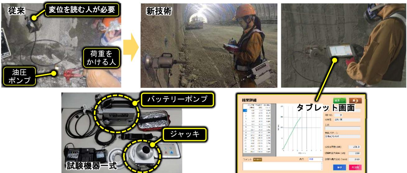
図 3.2.3 ロックボルト自動引抜試験機
