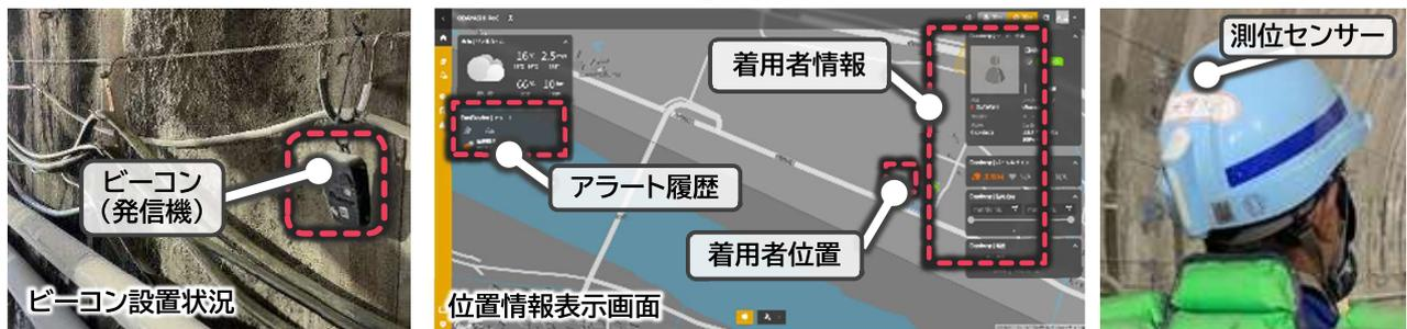
(b) 作業管理システム（作業員の作業エリア検知システム）
