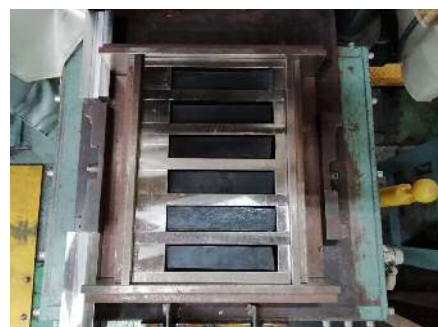
b) 成型した配合ゴムを金型に組込む
