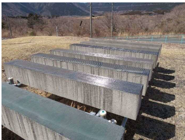
写真 3.2.2 暴露試験状況(2)：FRP シートによるコンクリートの補強試験体
