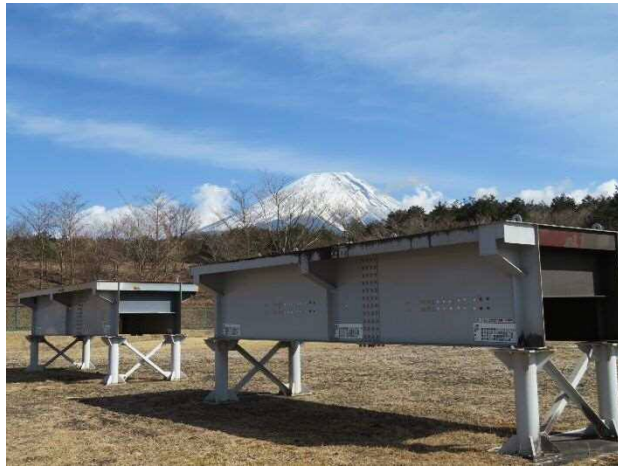
写真 3. 2. 3 暴露試験状況 (3) : 鋼材の防食塗料試験体
