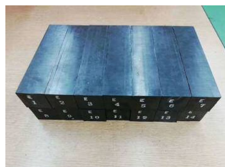
d) 完成したゴムブロック
