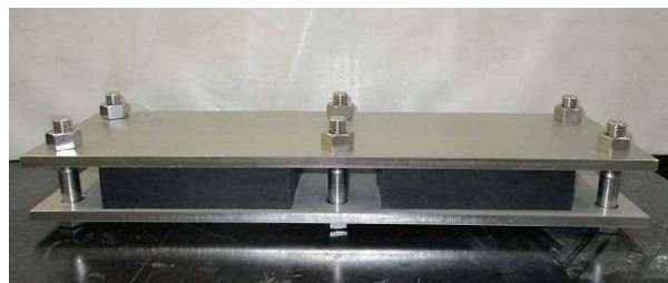
図 3.3.1 暴露試験用ゴム材と組込み用治具 (6 本 1 組を 2 組) (寸法単位 : mm)
