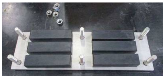
図 3.3.1 暴露試験用ゴム材と組込み用治具 (6 本 1 組を 2 組) (寸法単位 : mm)
