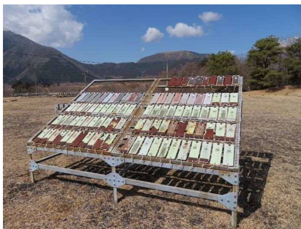
写真 3.2.1 暴露試験状況(1)：鋼材の防食塗料試験体
