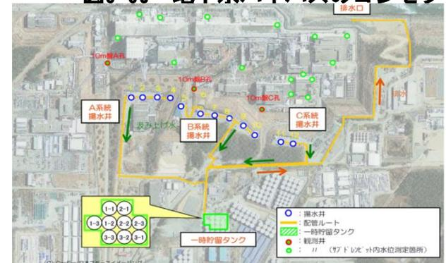
図3-41 地下水バイパス設備全体平面図
