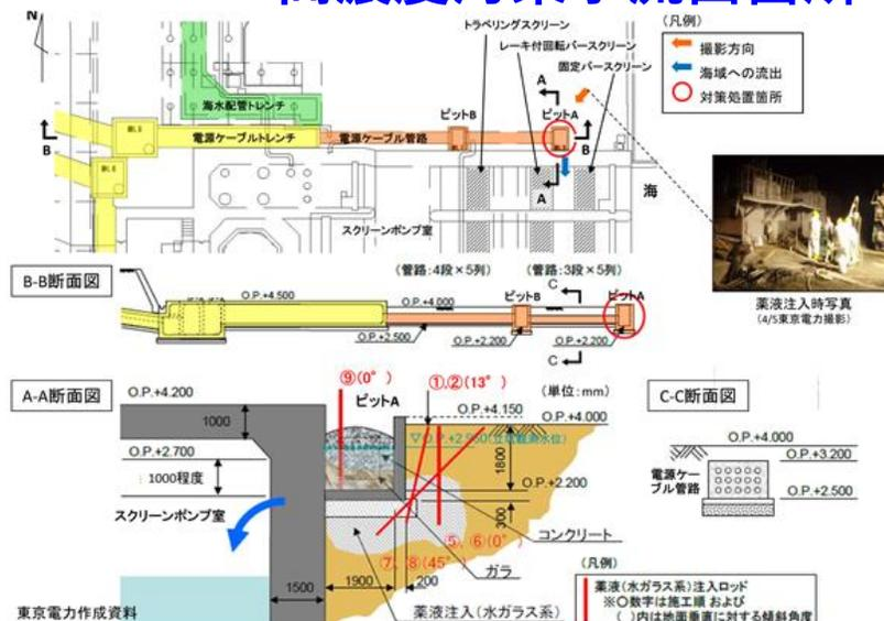
図 2-8 2号機取水口スクリーン室付近の流出防止対策
