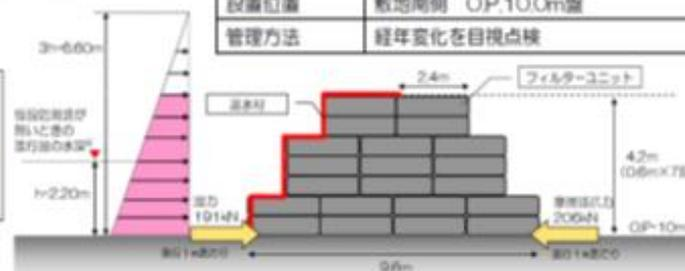
図 2-32 設計の考え方と仮設防潮堤の形状
