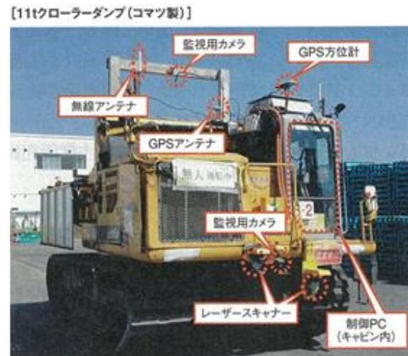
図 3-154 クローラードンプ自動走行システム
