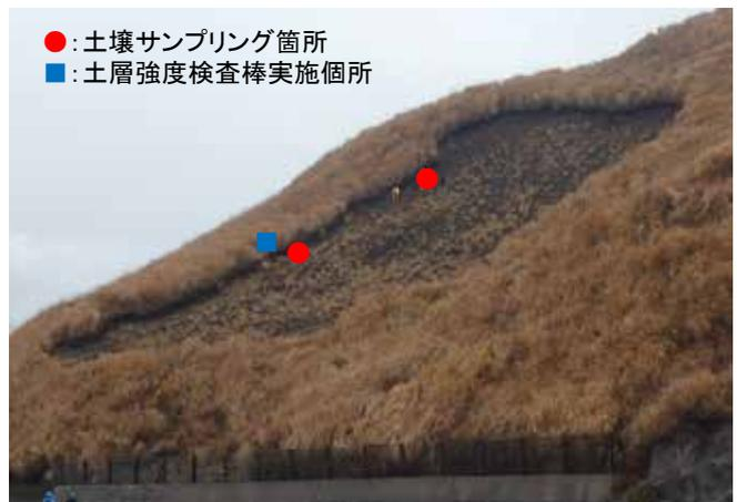
写真 3.3.4.6 試料採取箇所 (崩壊右側部下方)
