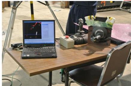
ジョイスティック遠隔操作装置
