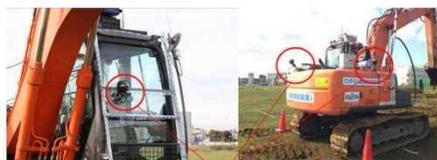
写真1 前後左右4台の魚眼レンズカメラ取付状況
