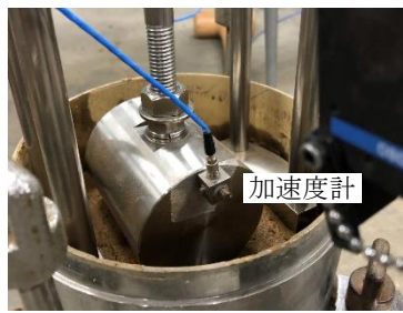
写真-4.3.2 重錘に貼り付けた加速度計
