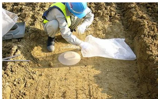
写真-3.2.2 砂置換法における砂充填
