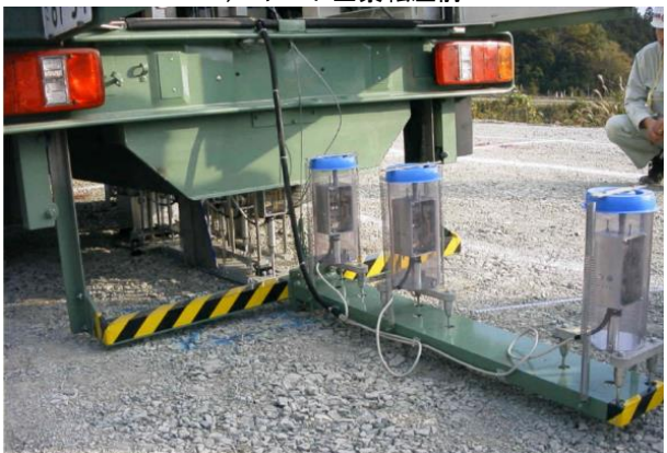
c) 動的平板载荷試験 (FWD 測定) 測定状況
