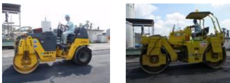
(a) 4t 級振動ローラ (SAKAI TW502-1) (b) 7t 級振動ローラ (SAKAI SW750)
