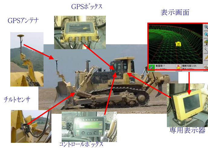
図-3.2.20 MC ブルドーザーとその施工例
