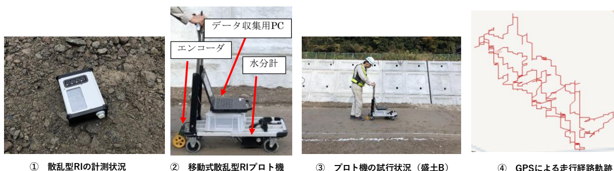
図-5. 7. 11 移動式散乱型 RI プロット機と試行状況（試験盛土 B）
