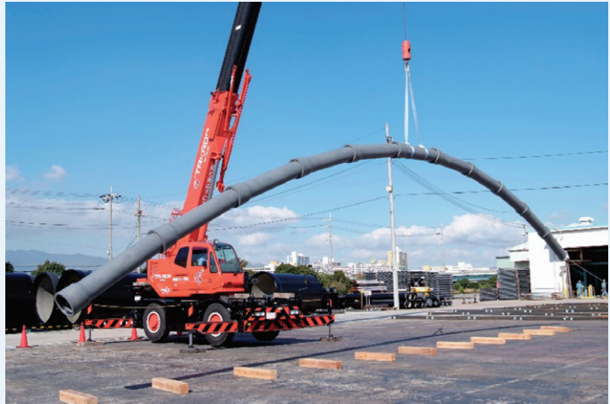
可撓性を有するダクタイル鋳鉄管 継手部分に伸縮、屈曲かつ離脱防止機能を有しているため、地震の動きに追従し、耐震性が確保されます。(提供：一般社団法人 日本ダクタイル鉄管協会)
