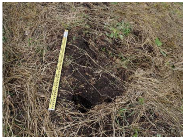
写真 3.3.15 破堤地点直上流部に見られた噴出跡と考えられる箇所
