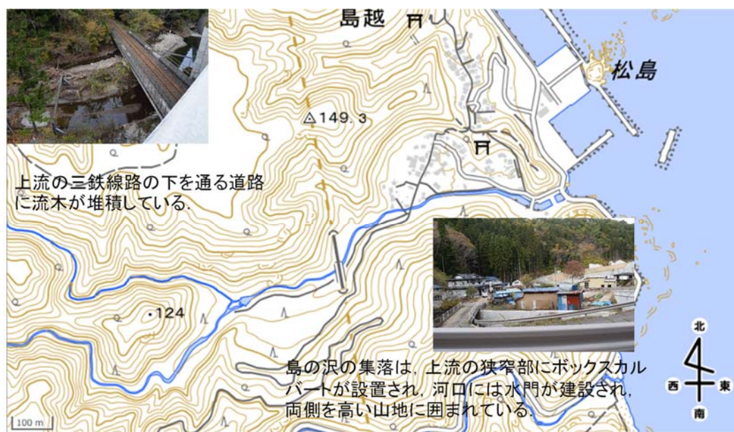
図 2.2.15 島の沢集落の被害と、鉄道橋周辺の流木堆積
