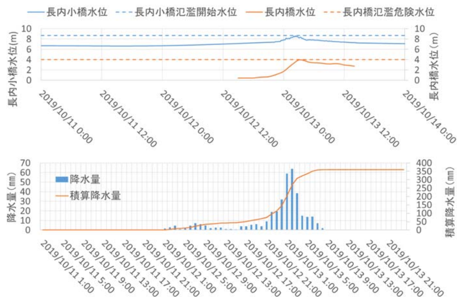
図 2.2.6 雨量と、長内橋（長内川）と長内小橋（小屋畑川、危機管理型水位計）の水位 （岩手県県北広域振興局土木部河川港湾課提供水位と気象庁 HP の雨量データ（久慈）を用いて作図）
