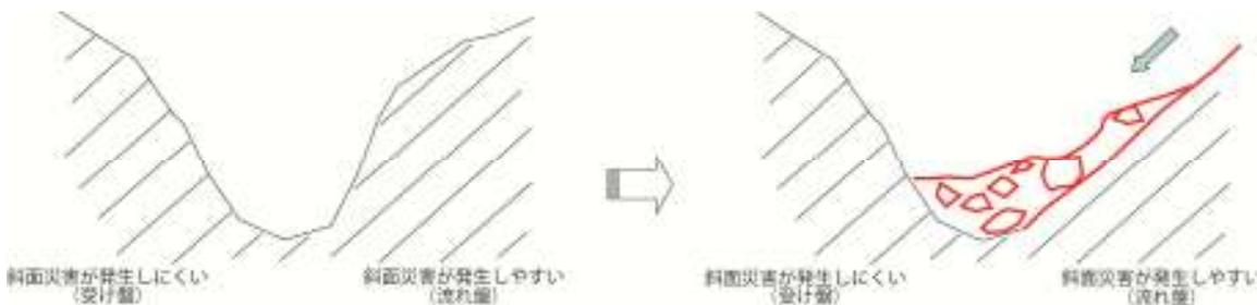
図 5-1-2-2 流れ盤と受け盤の図と特徴
