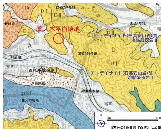
図 8.5 葉ノ木平地区斜面崩壊地付近地質図
