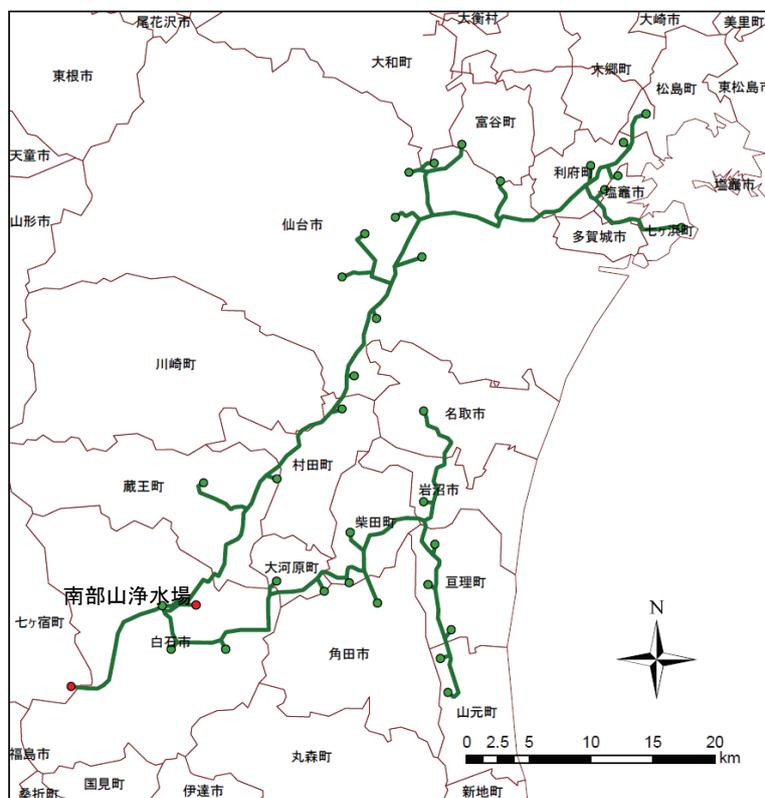
図 10.3-1 仙南・仙塩広域水道の送水管網図 (HPに基づき作図)
