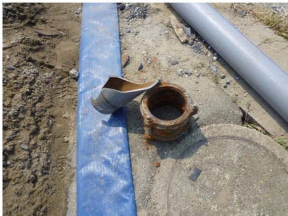
写真 10.6-39 VP管のドレッサー継手
