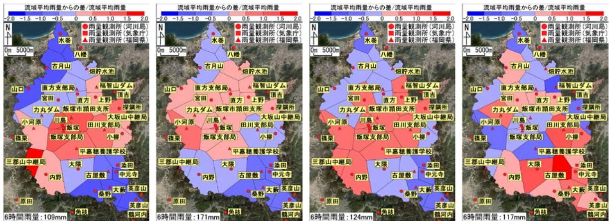
図 7.4 6時間雨量と流域平均雨量との差の分布図（左から，2003年，2009年，2010年，2012年）
