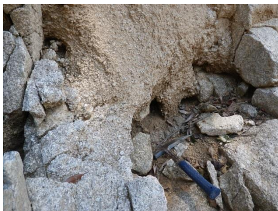
図 4-61 基岩との境界見られたパイプフロー跡
