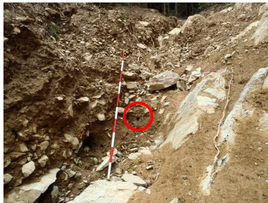
図 4-27 地点 H でみられたパイプフロー跡
