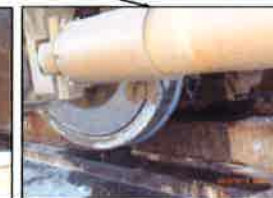
6号車3位 ギヤケース破損
