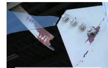
ブレースの破断（孔欠損部）
